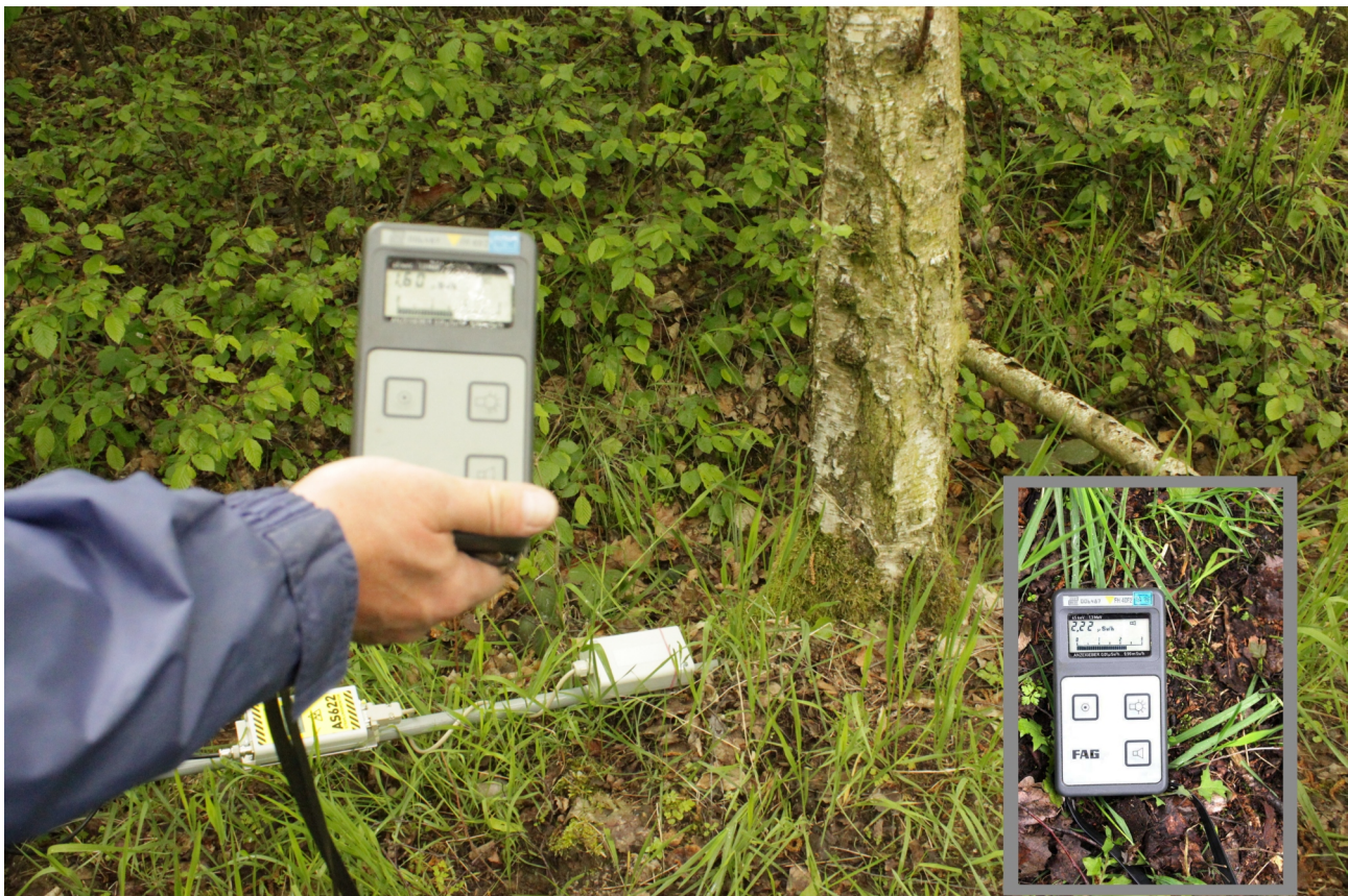
Foto 18: ODL-Messung an Hotspot #2 – links im Bild: Hintergrundstrahlung am gleichen Ort direkt am Boden angezeigt werden 2,22 \mu\text{Sv/h} (kleine Aufnahme links: Karsten Hansky, große Aufnahme & Grafik: Grit Ruhland)
