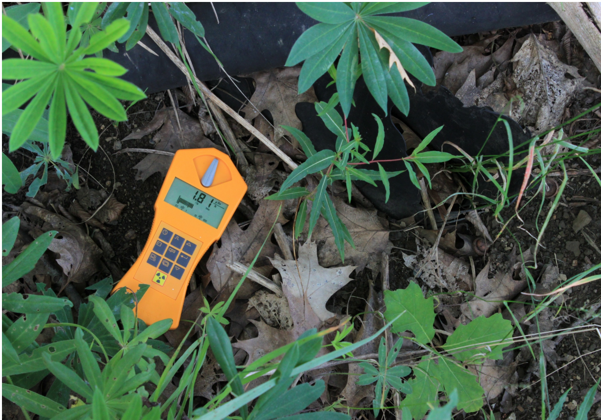
Foto 17: Relikte des Uranbergbaus am Beobachtungsort R4 (Gummischlauch, Gummistiefel, Gestein – letzteres links neben dem Geigerzähler). Der Geigerzähler zeigt eine Hintergrundstrahlung von 1,81 \mu\text{Sv/h} an (Aufnahme: Grit Ruhland, Juni 2016). Der Ort wird in diesem Unterkapitel als „Hotspot #1“ bezeichnet.
