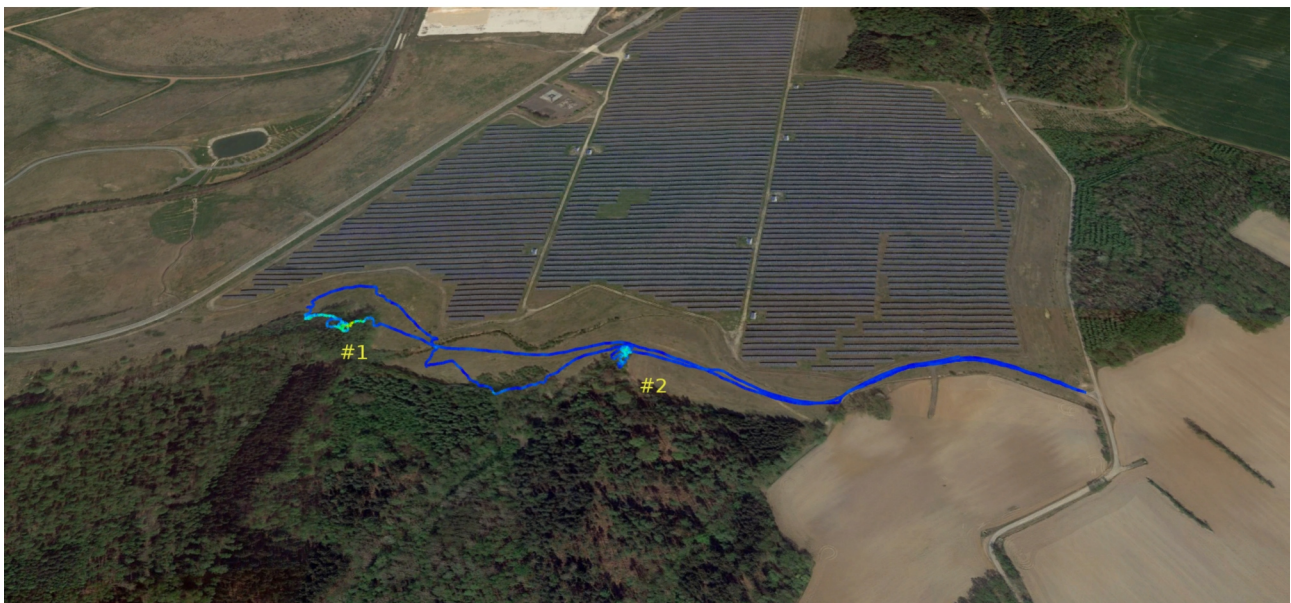
Schaubild 14: Visualisierung der Daten des "Gammabesens" (ODL+GPS) aus der Begehung im Mai 2019 des Beobachtungsortes R3 und R4 auf Satellitenbilder (Google Earth) ; Farbtemperatur des Tracks indiziert Höhe der Gammastrahlung – niedrige Strahlung blau, erhöhte rot (Grafik: Karsten Hansky)
